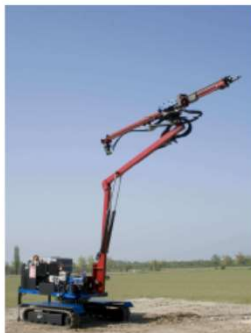
Perforation horizontale hauteur maxi 5300 mm Horizontale Bohrung Maximale Höhe 5300 mm
